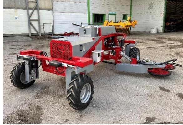
**Cancon, le 06/02/2024** : RoboCut360 est un véhicule autonome qui permet de couper automatiquement les drageons au pied des arbres mais aussi de tondre l'herbe entre les arbres et dans les allées. Il offre une solution aux arboriculteurs qui souhaitent tailler et tondre mécaniquement tout en diminuant la charge de travail et le besoin de main d'oeuvre.
